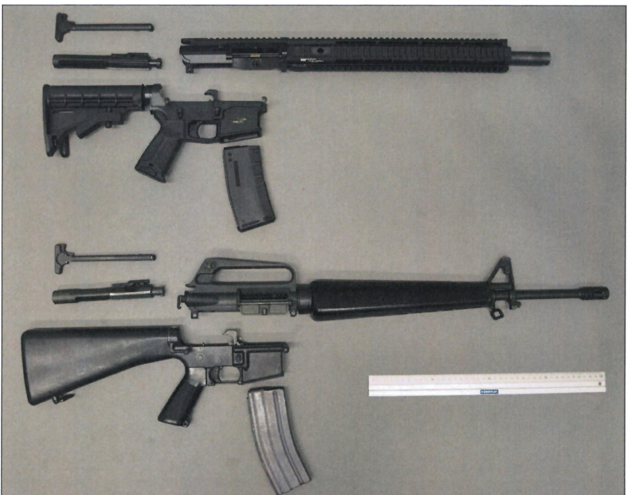
Abbildung 13: oben „The15th“, unten „AR16A1“, zerlegt in Hauptbaugruppen
