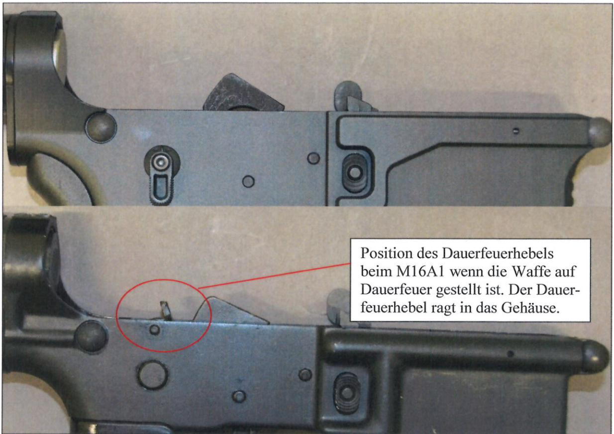
Abbildung 10: Schlaghähne gespannt und M16 auf Dauerfeuer gestellt, oben „The15th“, unten „M16A1“
